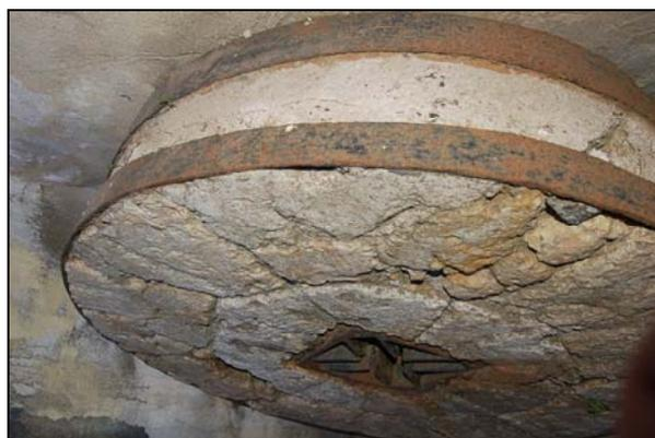
En las muelas confeccionadas con trozos de calcedonia, los ubicados hacia el centro pueden ser de uno hasta cuatro bloques. En cambio las porciones perimetrales, son cuadriláteros con el lado mayor orientado
