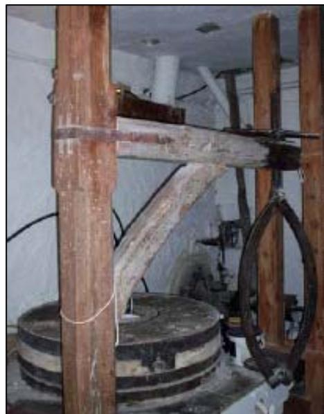
La cabria reside en una grúa en forma de tijera de brazos curvos de hierro, en forma de media luna, con la cual se desplazaba la muela. Consiste en un pescante vertical que se sitúa entre la bancada y el techo, cumpliendo la función de sostener el peso del mecanismo que permite girar del mismo. El extremo distal de ambos brazos posee pernos que se insertan en los orificios laterales de las muelas, permitiendo la elevación y rotación de las mismas.
